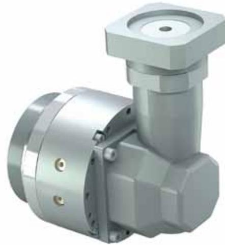
Präzisionsgetriebe mit der Möglichkeit der Verbindung senkrecht zur Achse der Ausgangswelle ermöglicht gleichzeitig die Erhöhung der Gesamtübersetzung durch das Winkelgetriebe. Diese Lösung ermöglicht die Verwendung des Servomotors mit niedrigerer Leistung und höherer Motordrehzahl und kann für alle Baugröße der TwinSpin Getrieben Serie E verwendet werden.
